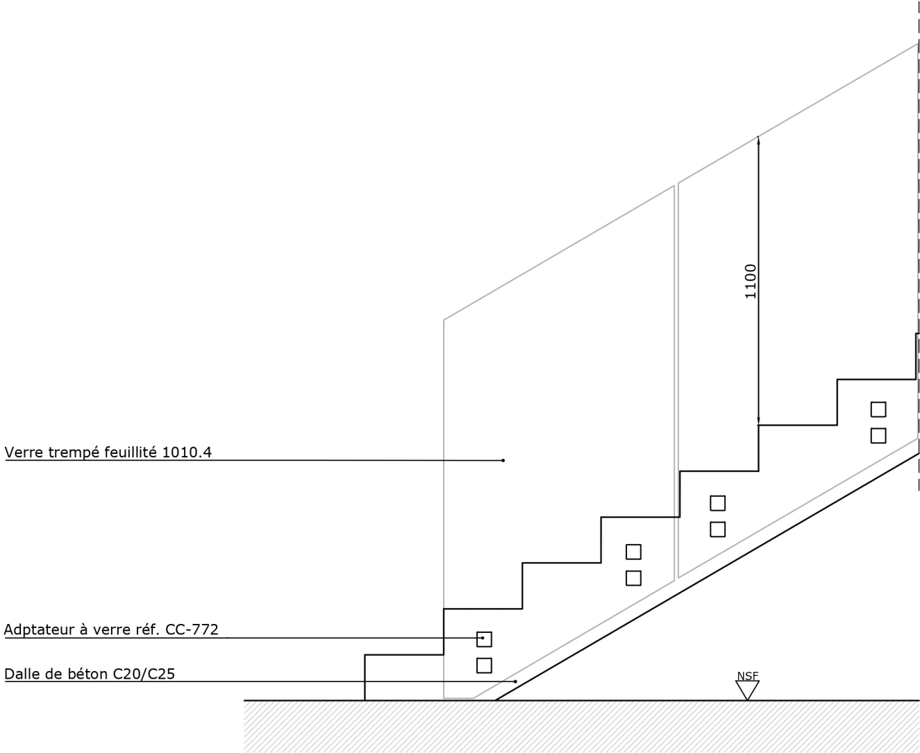
Détail de début d'escalier GlassFit CC-772 Sans main-courante Échelle 1:20
